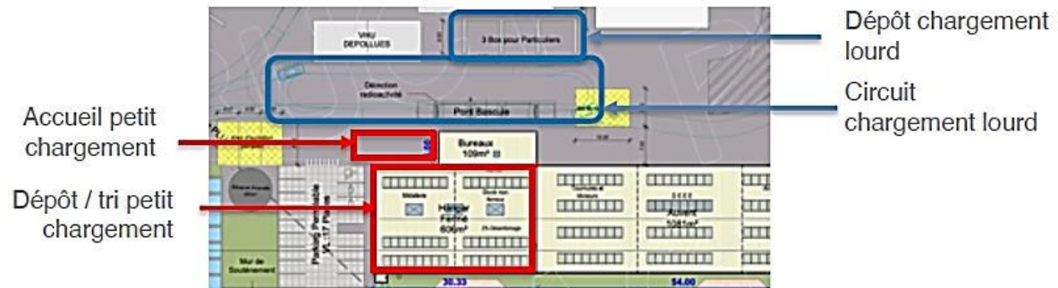
Figure 16 : Disposition d'accueil des particuliers / petits apporteurs
